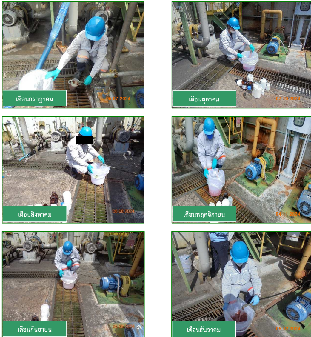
ภาพที่ 3.25 การตรวจวัดคุณภาพน้ำ จุด Weak Acid Wastewater Treatment Plant (บ่อกรด)
