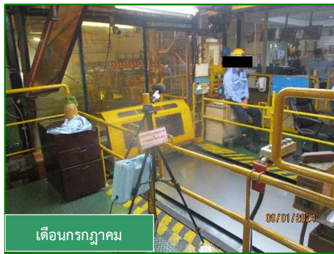
ภาพที่ 3.55 การตรวจวัดระดับเสียงในสถานที่ทำงานบริเวณ Inspection RCL Delivery
