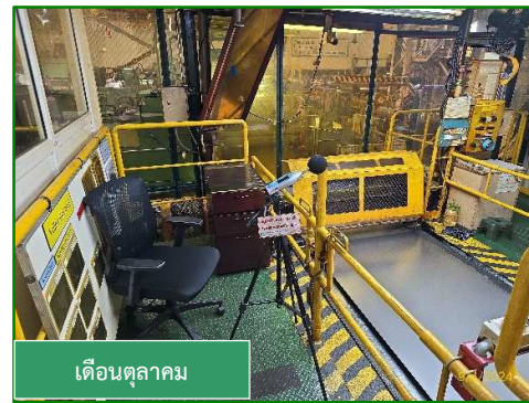
ภาพที่ 3.55 การตรวจวัดระดับเสียงในสถานที่ทำงานบริเวณ Inspection RCL Delivery
