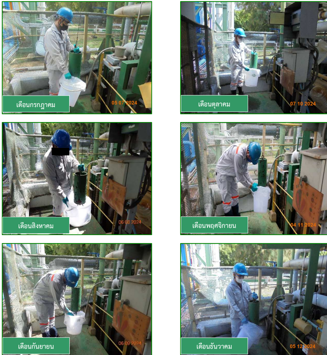
ภาพที่ 3.27 การตรวจวัดคุณภาพน้ำ จุด Inspection Pit (บ่อรวมน้ำเสียก่อนระบายลงสู่บ่อรวมน้ำเสียของนิคมฯ)
