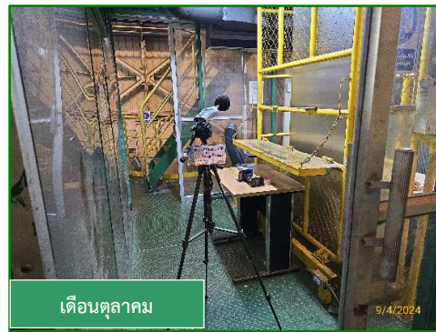
ภาพที่ 3.51 การตรวจวัดระดับเสียงในสถานที่ทำงานบริเวณ Inspection CAL Delivery
