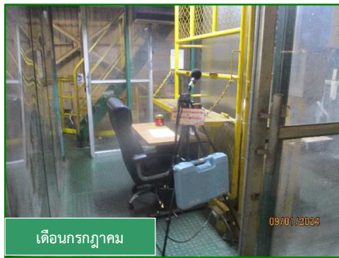
ภาพที่ 3.51 การตรวจวัดระดับเสียงในสถานที่ทำงานบริเวณ Inspection CAL Delivery
